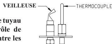
8. Trouver la veilleuse - suivre le tuyau de métal à partir du contrôle de gaz. La veilleuse est située entre les deux tuyaux des brûleurs, derrière le couvercle d'accès à la veilleuse.
